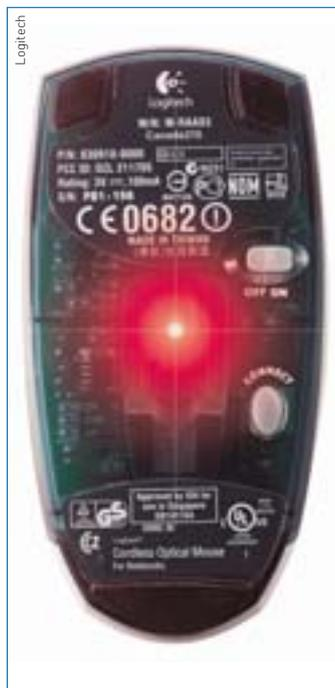
Ein Beispiel für Cross Industry Innovation: Im Nähfuss von Bernina misst ein optischer Standard-Maussensor die Geschwindigkeit des Stoffes beim Patchwork-Nähen.
